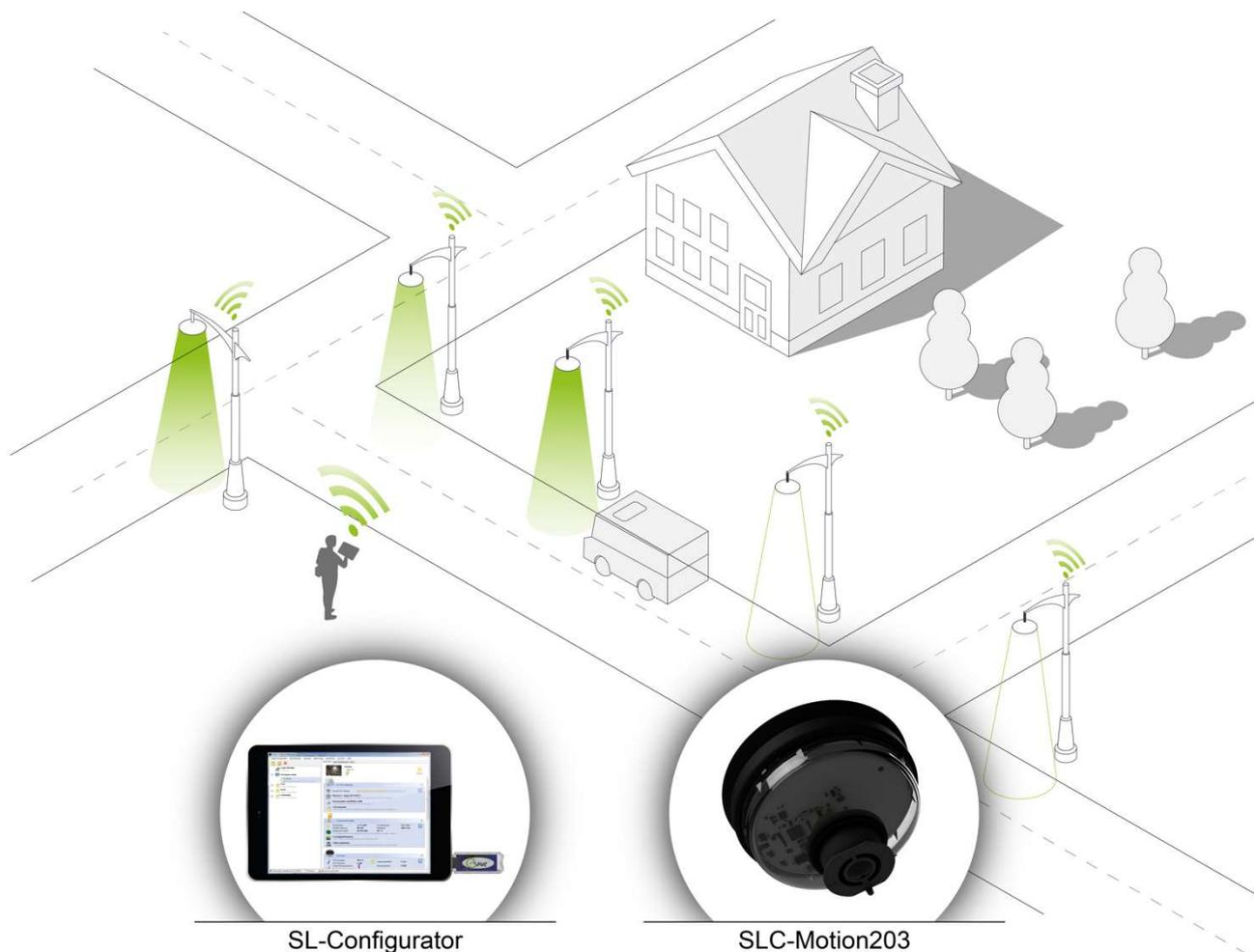
Die Kommunikation wird über ein automatisches, organisierendes 2.4 GHz Mesh-Netzwerk sichergestellt. Jede Strassenleuchte kommuniziert mit allen im Umfeld erreichbaren Leuchten.
