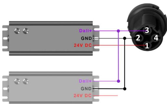
**Hinweis:** Der Controller unterstützt bis zu 4 LED-Treiber gleichzeitig.
